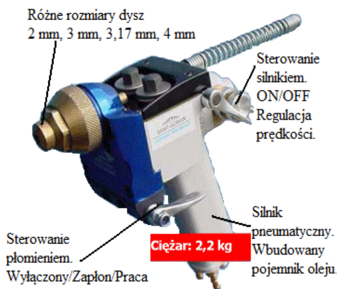
Rys. 63. Pistolet do metalizacji natryskowej Z – JET [25].
